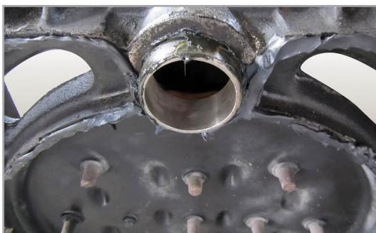
**Βήμα 8:** Ξεκινώντας με το οπίσθιο στοιχείο τοποθετείστε τα νίπελς μέσα στις φωλιές (πάνω και κάτω) και εφαρμόστε τα κατά περίπου 1/4 του πλάτος τους στις φωλιές, με ελαφριά χτυπήματα ξύλινου σφυριού με λάστιχο ή δέρμα (μην χρησιμοποιήσετε ποτέ μεταλλικά σφυριά).
